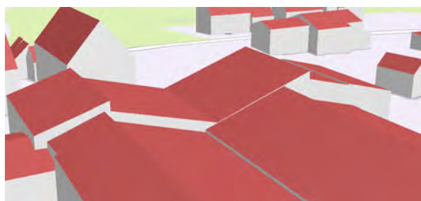
Abbildung 4.7: Hierbei werden fehlerhafterweise zwei Pultdächer für falsch deklariert, welche sich aber am First nicht berühren
